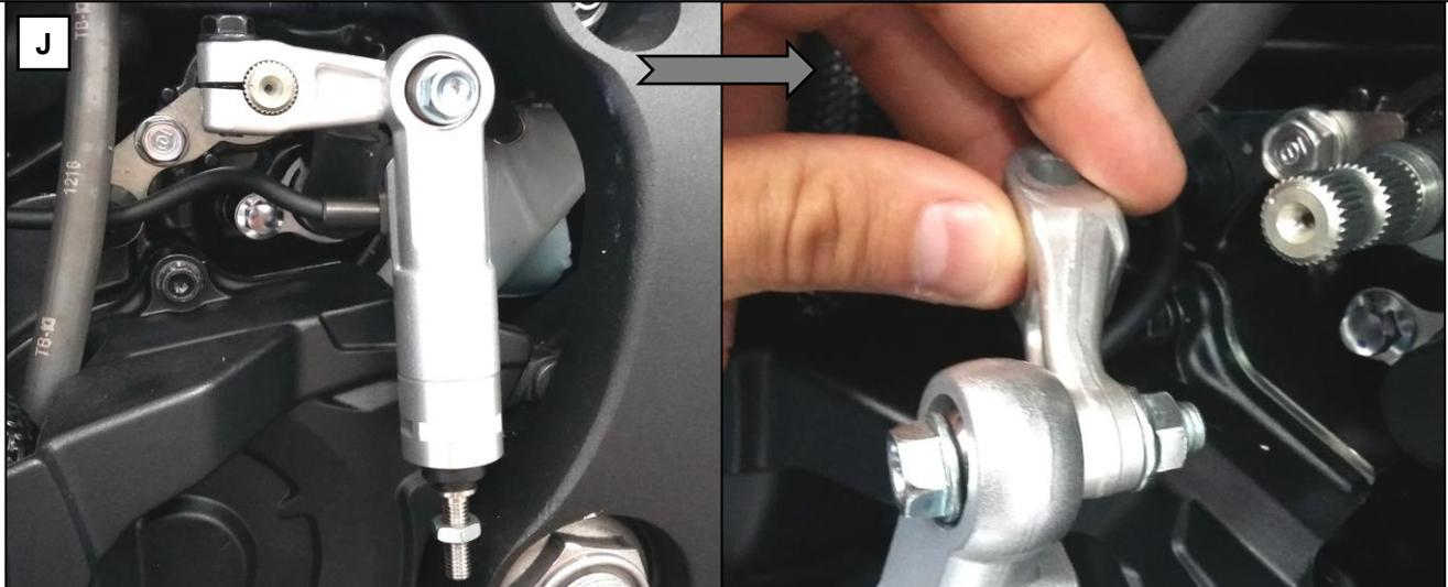
**J:** Entfernen Sie den Schaltarm samt Schaltautomat von der Getriebeausgangswelle.
