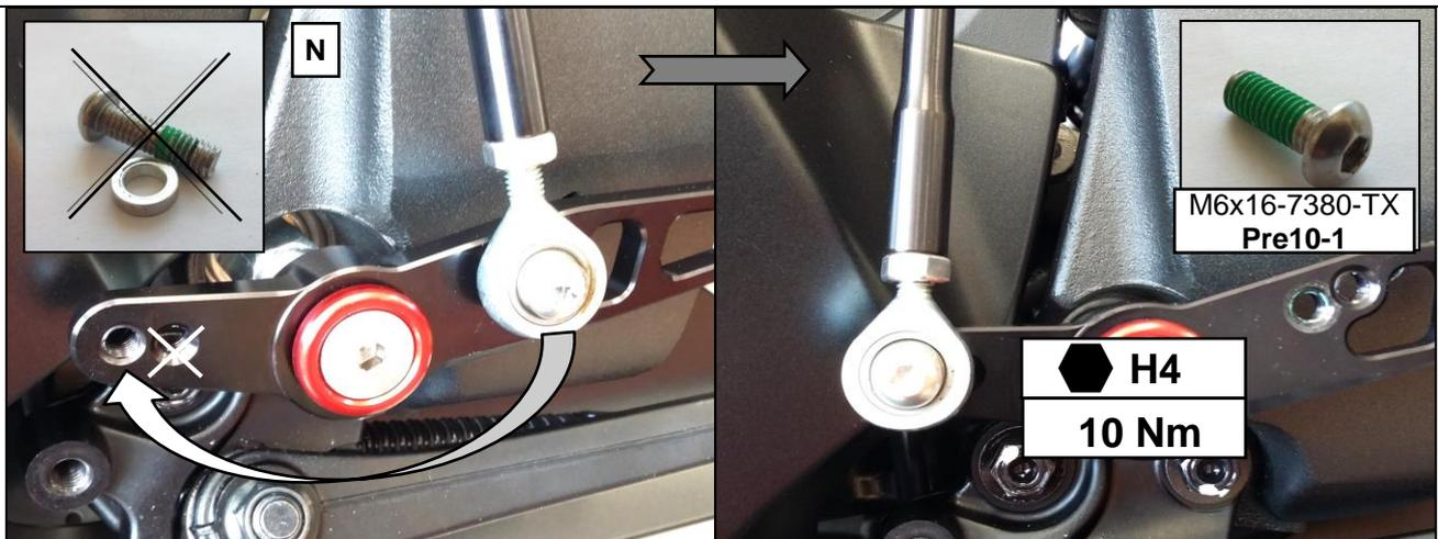
**N:** Montieren Sie den Kugelkopf mittels Schraube **M6x16-7380-Pre10-1** an die vorderste Position des Schalthebels US-10.
